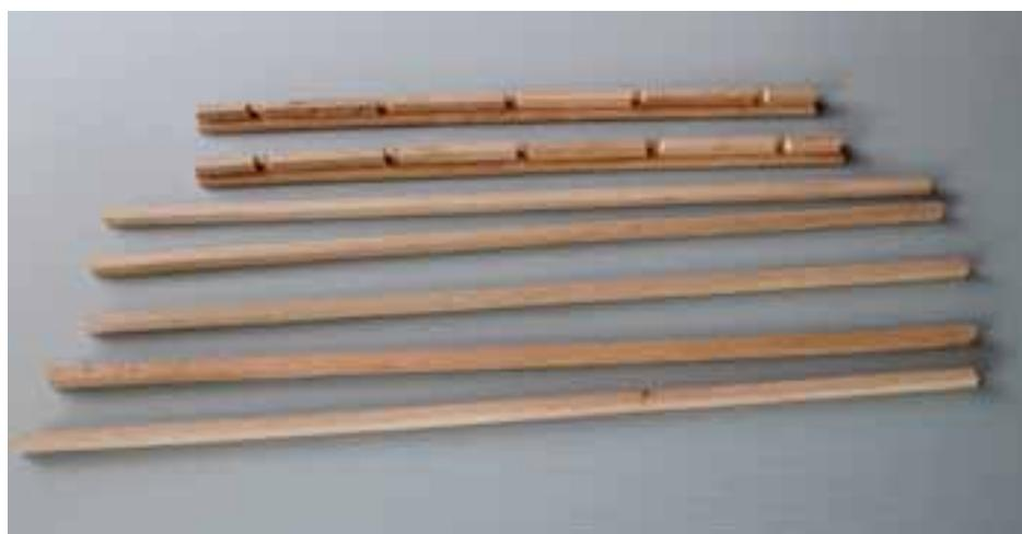
Fig. 2.2 Per realizzare questa struttura bastano alcuni listelli di legno quadrati (cinque nel nostro caso) e due assicelle piatte alle quali incolleremo degli elementi in fila, tutti della stessa lunghezza e con uno spazio per inserire le righe.
