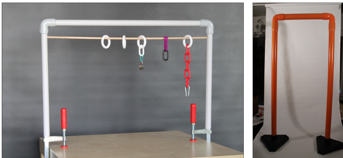
Fig. 3 Struttura verticale con morsetti applicata a un tavolino o da pavimento, con colonnine di segnalazione.
