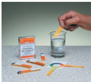
Мал. 11.3. Універсальним індикатором визначають приблизне значення рН
