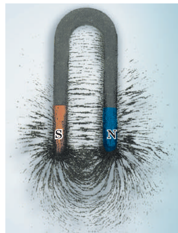
Рис. 2.4. Рисунок, утворений ланцюжками залізних ошурок, відтворює картину ліній магнітної індукції магнітного поля підковоподібного магніту
