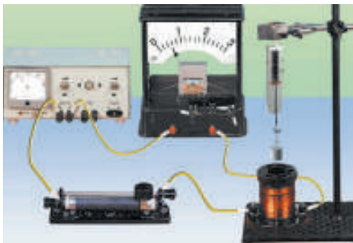
Рис. 6.1. Дослідження магнітної дії котушки зі струмом
