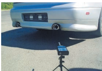
Рис. 5. Вимірювання рівня шуму від глушника автомобіля
