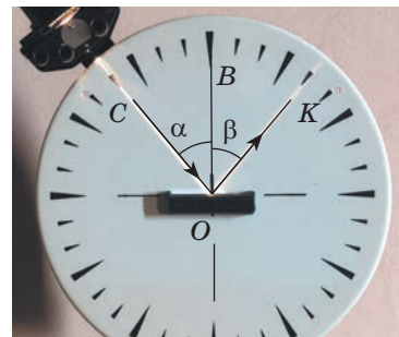
Рис. 11.2. Установлення законів відбивання світла за допомогою оптичної шайби: \alpha — кут падіння; \beta — кут відбивання
