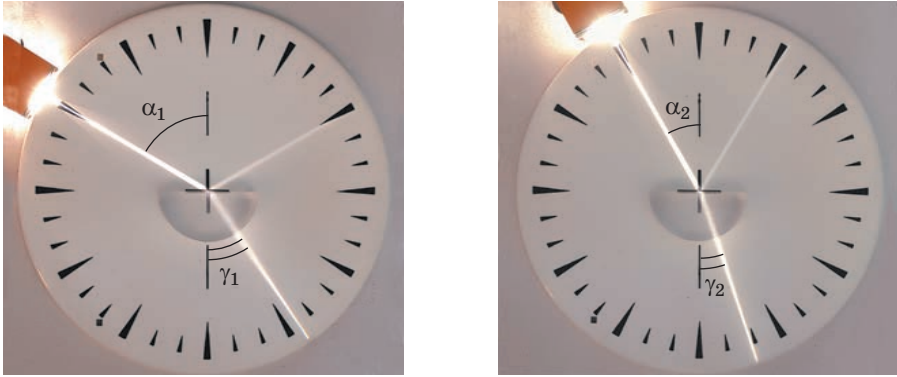
Рис. 12.3. Установлення законів заломлення світла: в разі зменшення кута падіння ( \alpha_2 < \alpha_1 ) кут заломлення теж зменшується ( \gamma_2 < \gamma_1 ), при цьому \frac{\sin \alpha_1}{\sin \gamma_1} = \frac{\sin \alpha_2}{\sin \gamma_2}
