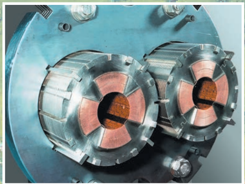
Рис. 2. Надпотужні магніти, які утримують заряджені частинки всередині прискорювача
