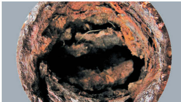
Мал. 48.2. Результати діяльності залізобактерій у водопровідних трубах
