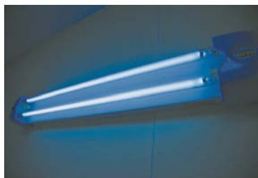
Мал. 19.4. Кварцову лампу використовують для дезінфекції приміщень. Ця лампа — джерело ультрафіолету, під дією якого в повітрі утворюється озон, що вбиває бактерії. Слід пам'ятати, що ультрафіолетове світло від цієї лампи шкідливе для очей!
