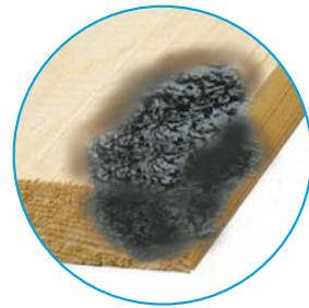
Мал. 22.2. Обвуглювання деревини концентрованою сульфатною кислотою
