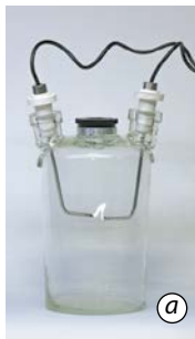
Мал. 23.1. Взаємодія азоту з киснем: у лабораторії (а) та в природі (б)
